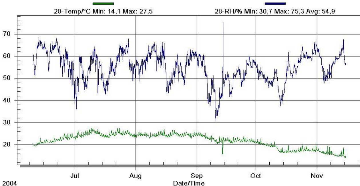
Graficul umiditatii si temperaturii obtinut cu senzorul 5 (amplasat in partea de sus a candelabrului din naos)
