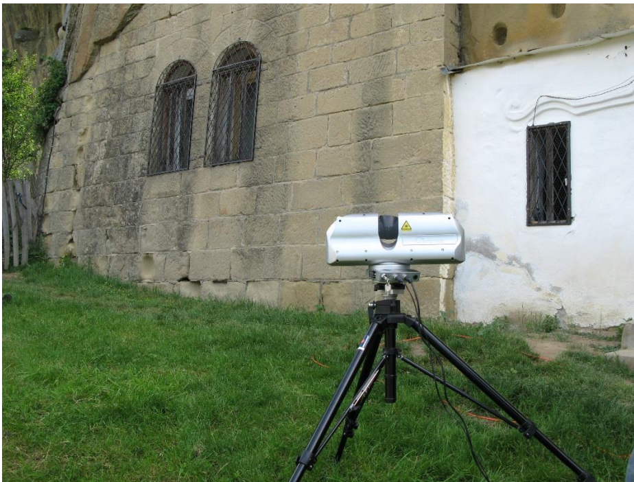
Amplasarea scannerului in exterior
