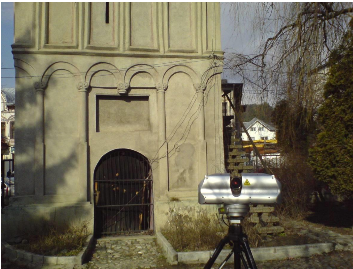
Fig 7 Scanarea fațadei interioare a Turnului Bărăției
